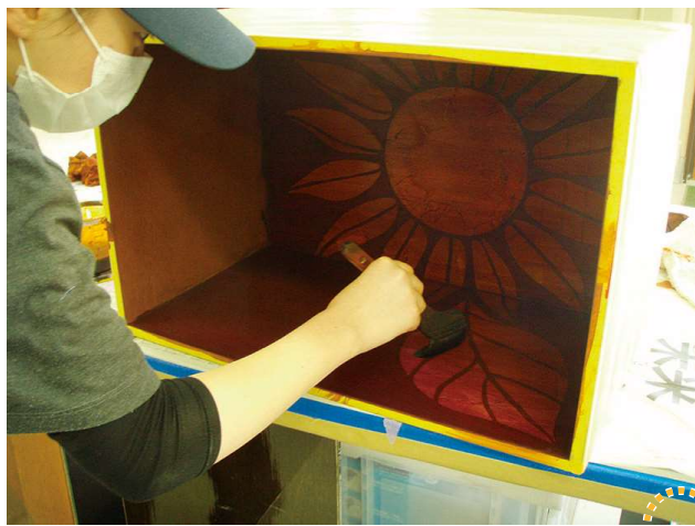
木工塗装作業 (着色作業)
