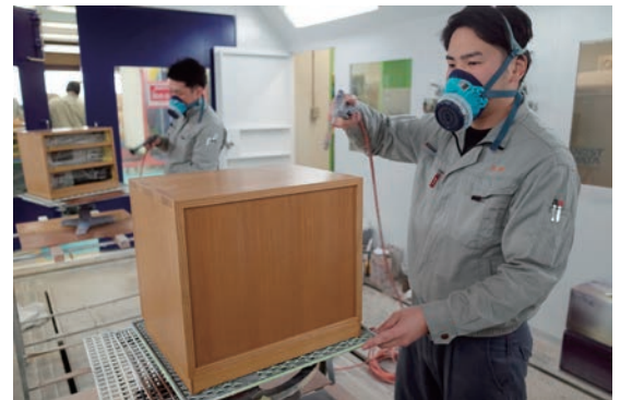
写真⑥：塗装作業
