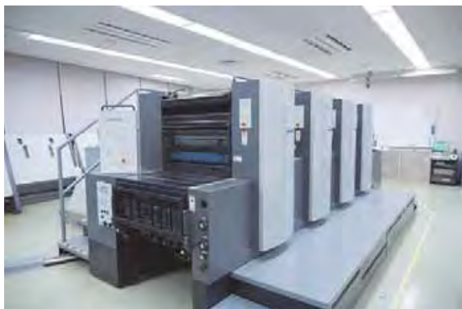
グラフィック印刷科で使用している4色機
