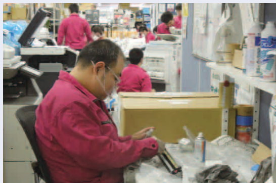
複合機の内部を徹底的に清掃する
